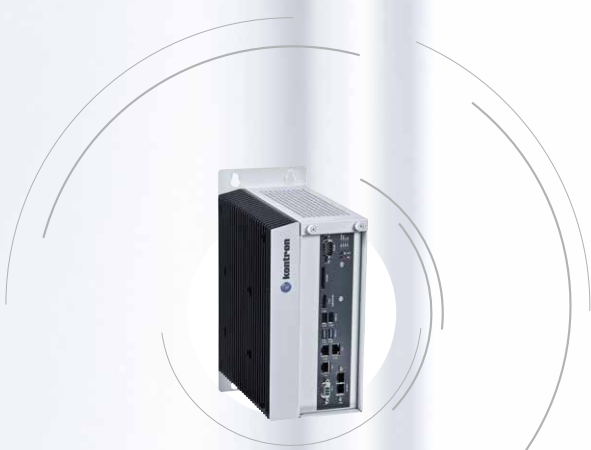
K-BOX A103 High-Performance embedded BoxPC, lüfterlos und mit „wartungsfreiem“ Design.
