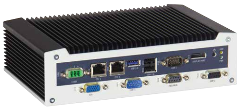
K-Box ist eine modular aufgebaute industrielle Computer-Plattform mit „wartungsfreiem“ Design.
